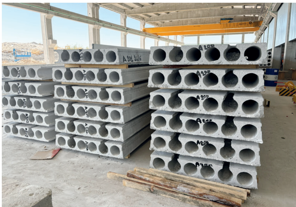
Пустотные плиты перекрытия на складе, готовые к отгрузке на стройплощадку
