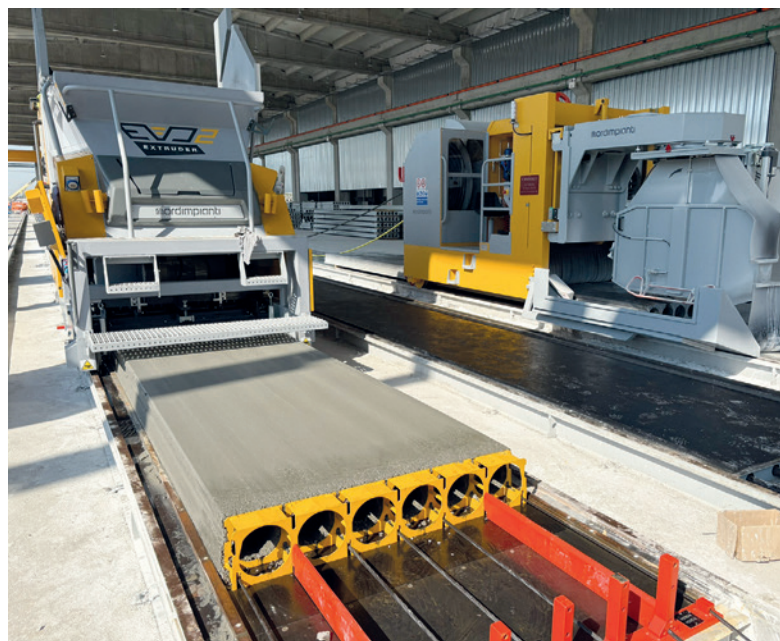
Использование стартовой пластины в начале производственной линии для сокращения отходов
