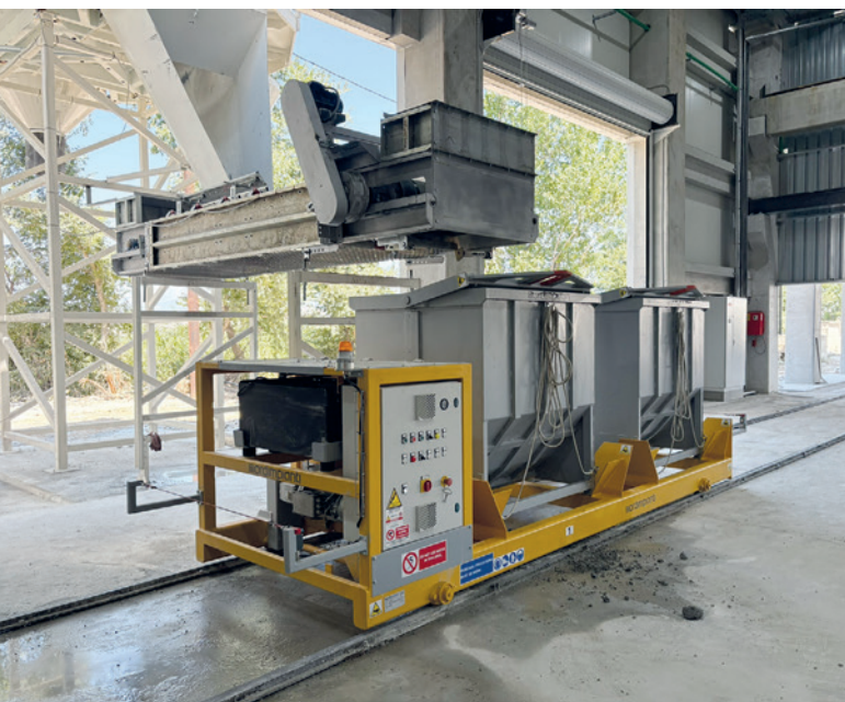
Тележка для транспортировки бетонораздаточных ковшей с аккумуляторным питанием
